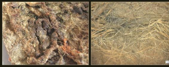
Aspetto del geotessile Terram 2000, dopo 3 anni. A sinistra, lato superiore; a destra, lato inferiore.
