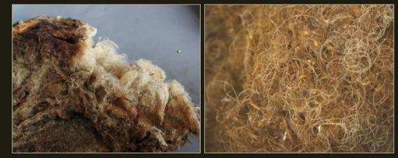
Porzioni del geotessile con evidente sfrangiamento delle fibre.
